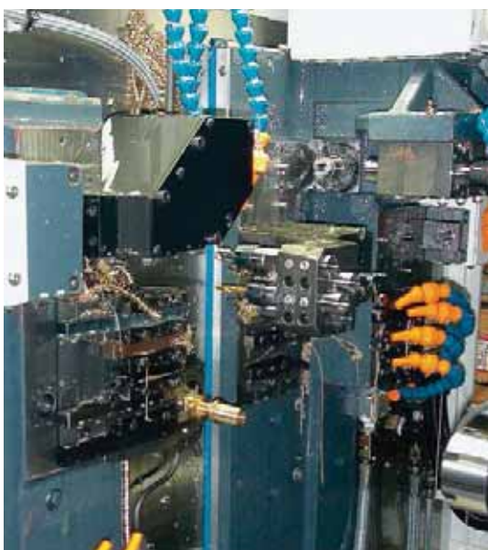
Swiss ST 26 fazendo um corpo de conector.
