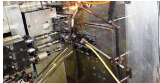
Deco 10 cortando un contacto de conector.
