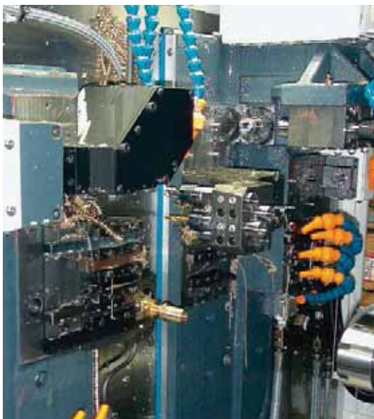
ST 26 de tipo suizo realizando un cuerpo de conector.
