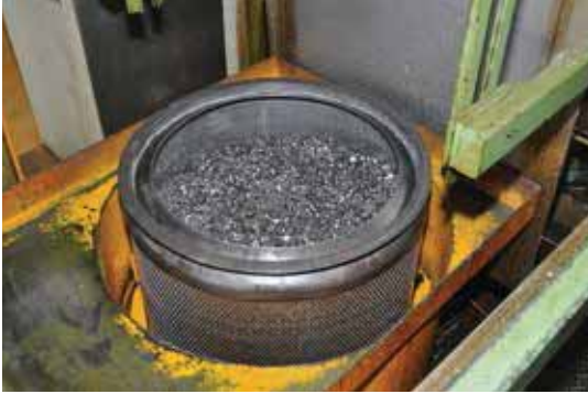
Motorex Ortho NF-X切削油具有很低的挥发性，切屑可以很容易地分离出去，因此排油减少到最低限度，只需偶尔添加新油。
