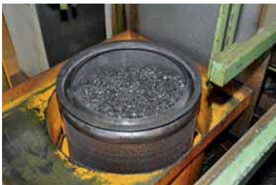
Das Schneidöl Motorex Ortho NF-X ist besonders verdampfungsarm und kann gut von den Spänen abgeschleudert werden. So kann der Ölaustrag auf ein Minimum reduziert und lediglich von Zeit zu Zeit Frischöl beigegeben werden.
