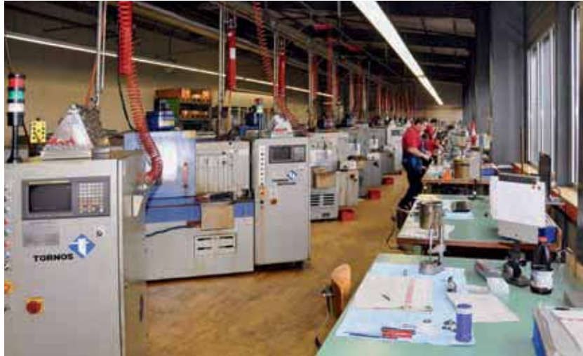
Le officine di produzione a Biberist lavorano efficacemente 24 h/24. A tale scopo RB-Cema AG utilizza esclusivamente dei torni multimandrini Tornos.
