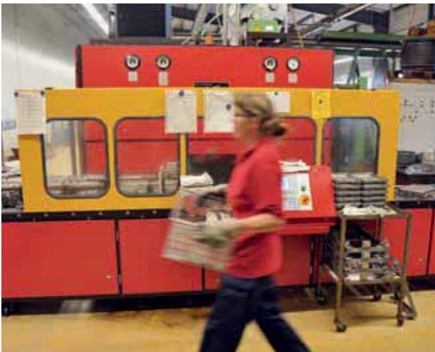
Prima della misurazione automatica, i particolari vengono puliti in un tunnel di lavaggio performante. I 10 collaboratori dell'azienda mettono il loro savoir-faire al servizio dei clienti.
