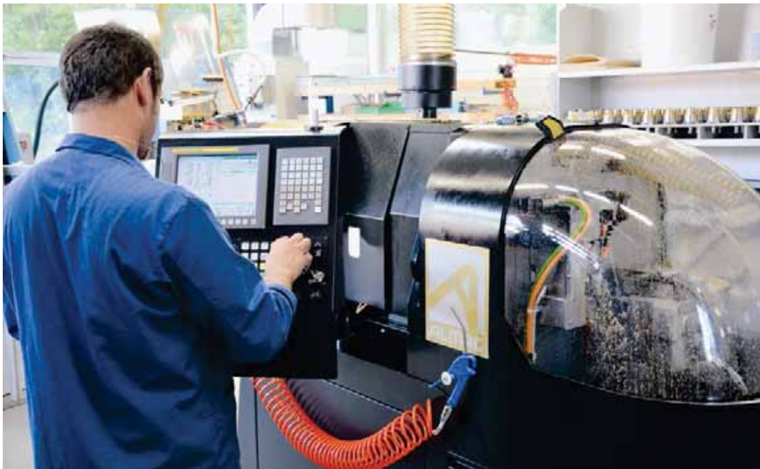
A BA 1008 está ligada ao sistema central de aspiração de névoa de óleo da Metalem.
