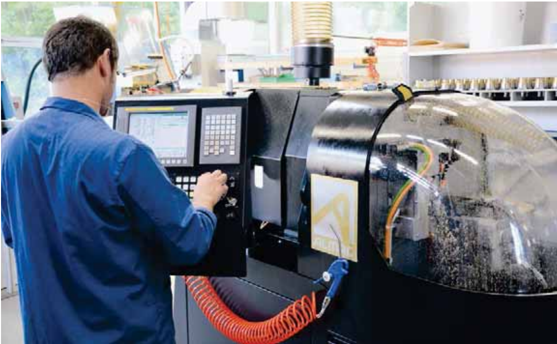
BA 1008机床与Metalem的中央油雾抽吸系统连接。
