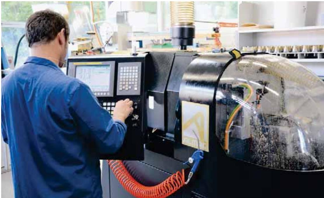
Die BA 1008 ist an ein zentrales Ölnebel-Absaugsystem von Metalem angeschlossen.
