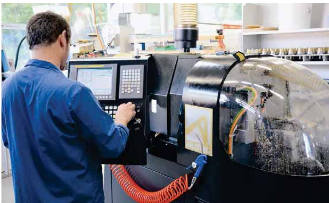
La BA 1008 è collegata al sistema di aspirazione delle nebbie d'olio di Metalem.
