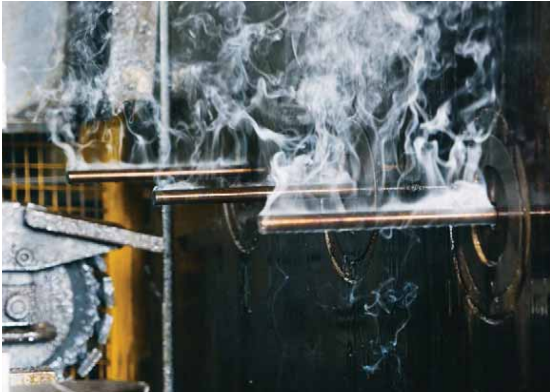
Die mechanisch-technologischen Eigenschaften der Spezialstahlsorten beeinflusst das Unternehmen unter anderem durch die Einstellung der Parameter beim Ziehen.
