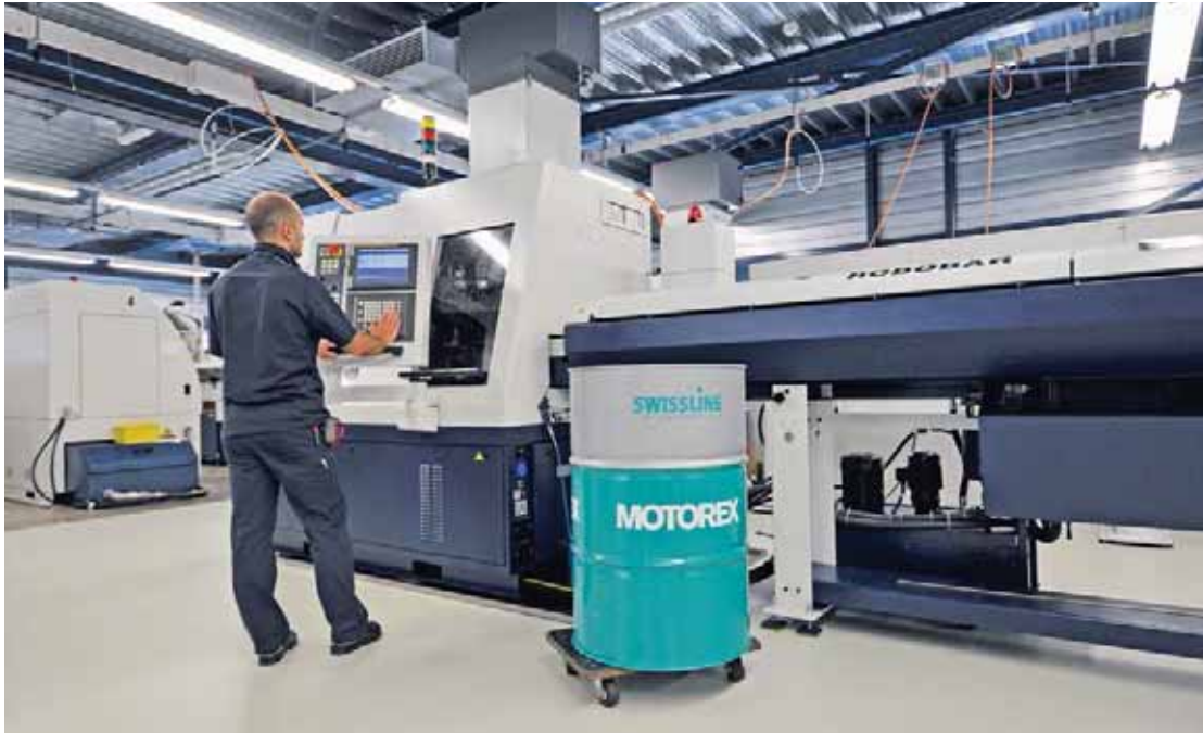
厂房建筑，都处在控制精确到23° C的空调环境中，通风良好，提供了一种特别舒心的工作环境，在这种恒定的温度条件下，始终能够确保复杂的机械加工工艺的可重复性。
