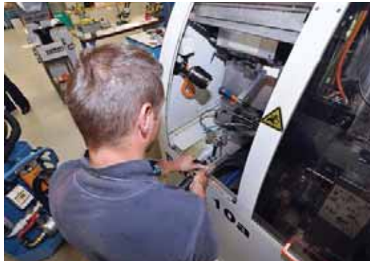
根据不同的材料和工艺，在经过精确定义的时间间隔之后要对机床进行清洁；作为这个过程的一部分，切削油也要进行精细过滤并且加满。因为没有中央供应系统，所以这都是单独进行的。
