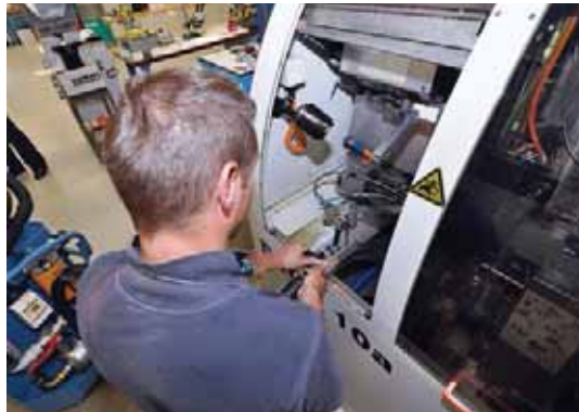
En función de los materiales y los procesos, las máquinas se limpian en unos intervalos definidos, en los cuales el aceite de corte se pasa por micro-filtros y se rellena. Esto se realiza máquina por máquina, ya que no se utiliza ninguna unidad de alimentación central.
