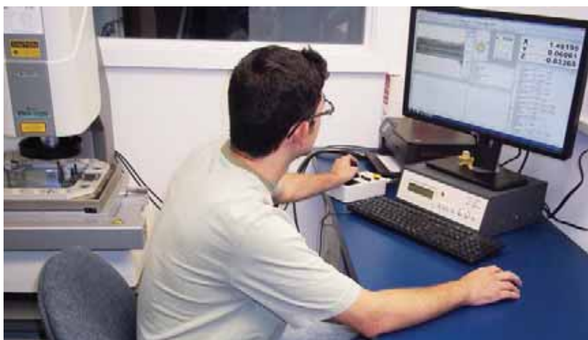
Um de nossos 4 engenheiros de controle de qualidade utiliza o sistema Laser Vision para verificar as dimensões de uma peça a partir de uma peça feita no nosso EvoDeco 32.
