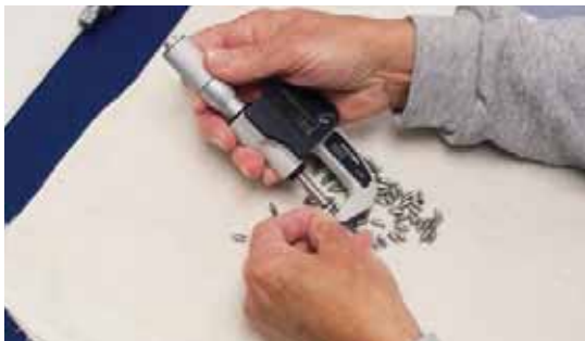
Os engenheiros de controle de qualidade utilizam um micrômetro digital para verificar as tolerâncias estreitas de uma peça feita em uma de nossas SwissNanos.
