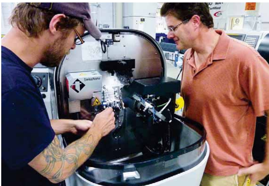
Nosso gerente de CNC e gerente de planta fixam um bloco de ângulo de 7 graus em uma de nossas SwissNanos para fabricar uma peça para clientes dos setores médico e eletrônico.
