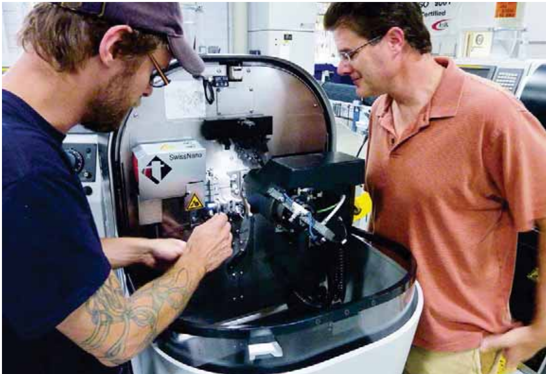
数控经理和工厂经理正在一台新的SwissNanos机床上安装7度角规，以便加工用于医疗和电子行业的定制部件。
