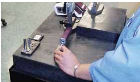
质量控制工程师使用表面光度仪在检查Tornos EvoDeco 32机床加工的零件的内径光洁度。
