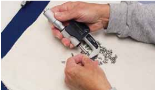
质量控制工程师正在使用数字千分尺检查在SwissNanos机床上加工的工件的严格公差。
