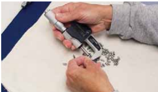
Qualitätssicherungs-Ingenieure prüfen mit einem Digital-Mikrometer die engen Toleranzen eines Teils, das auf einer unserer SwissNanos hergestellt wurde.
