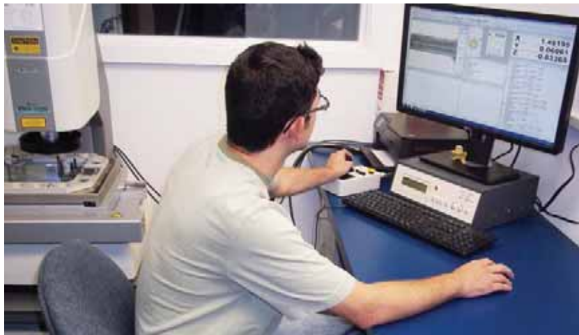
Einer unserer 4 Qualitätssicherungs-Ingenieure bei der Arbeit mit einem Optischen Lasersystem, das die Abmessungen eines Teils vermisst, das auf unserer EvoDeco 32 hergestellt wurde.
