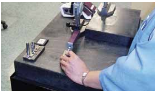
Qualitätssicherungs-Ingenieure prüfen mit einem Profilmessgerät die Oberflächenqualität des Innenumfangs eines Teils, das wir mit einer unserer EvoDeco 32 hergestellt haben.
