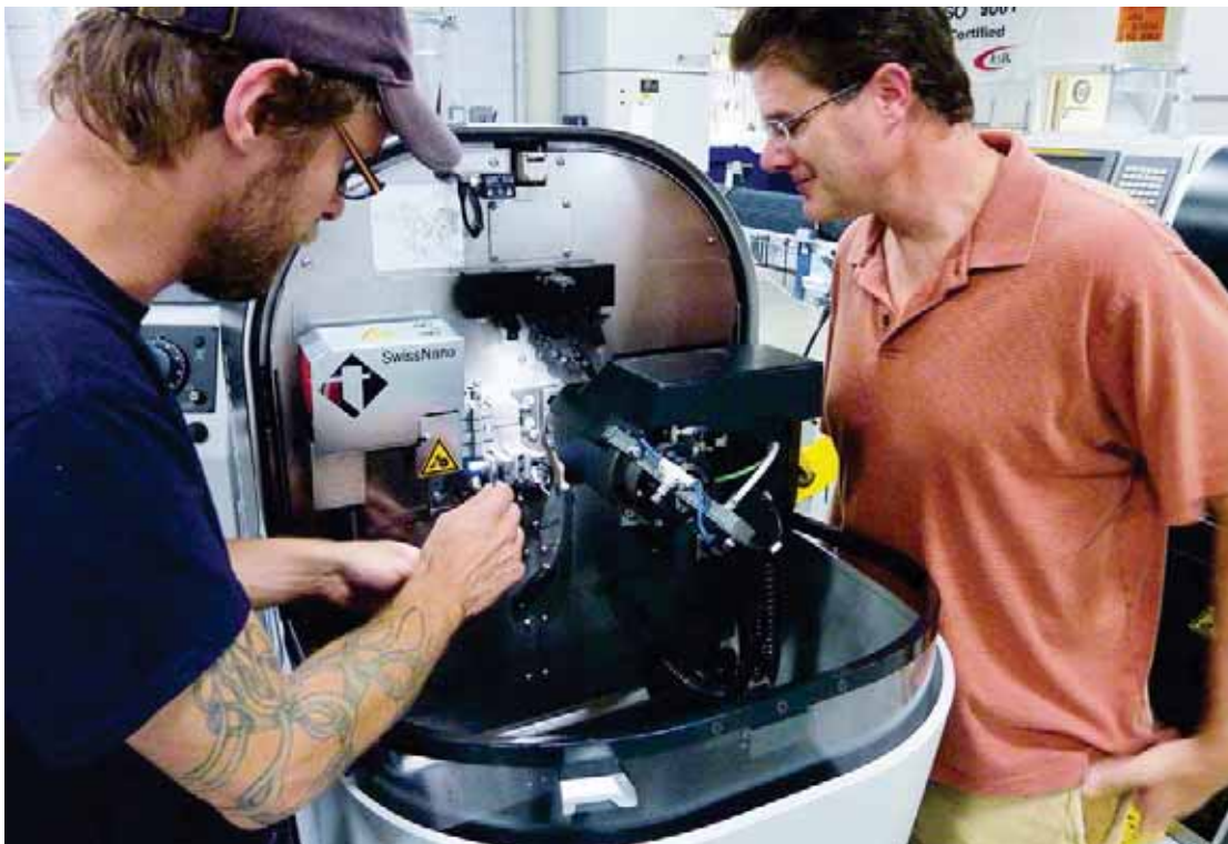
Nuestro Responsable de CNC y Responsable de planta instalando un bloque angular de 7 grados en una de nuestras nuevas SwisNano para fabricar una pieza personalizada para las industrias médica y de la electrónica.
