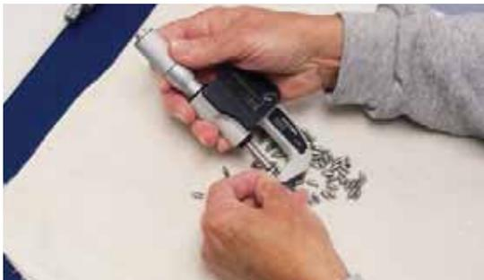
Ingegneri del controllo qualità mentre utilizzano un micrometro numerico per controllare le severe tolleranze di un particolare fabbricato su una delle nostre SwissNano.
