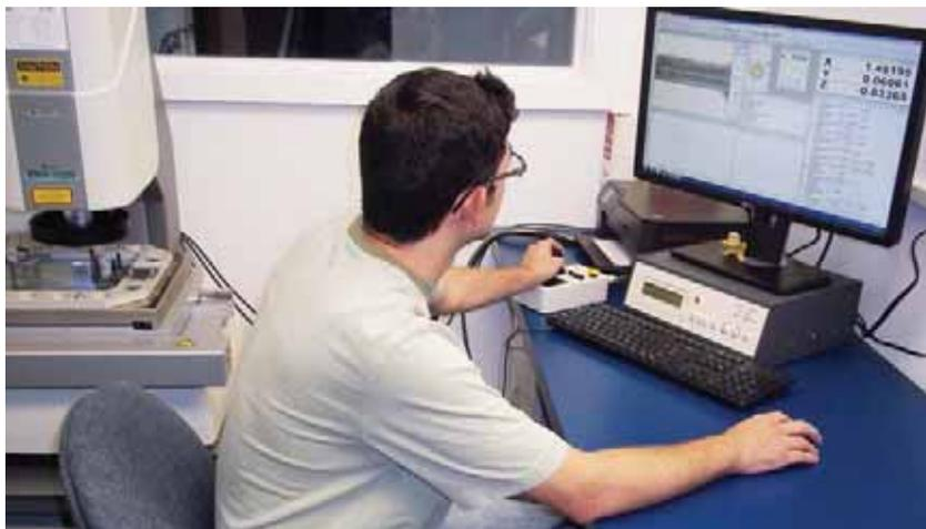
Uno dei nostri quattro ingegneri del controllo qualità utilizza un Sistema di visione laser per controllare le dimensioni di un particolare fabbricato sulla nostra EvoDeco 32.
