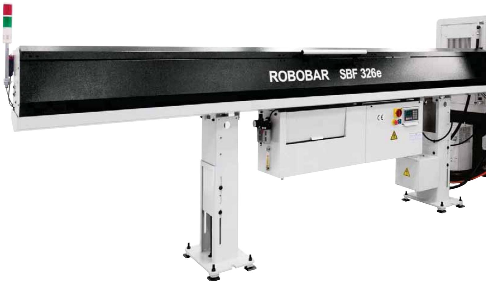
Desde la salida de las nuevas máquinas Swiss ST 26 y Swiss GT 26, los cargadores SBF 320 no eran capaces de cubrir la gama de diámetros requerida por estos nuevos productos dotados de un paso de barra de 25,4 mm. De esta realidad nace el cargador Robobar SBF 326e, y decomag ha querido conocer más detalles.
