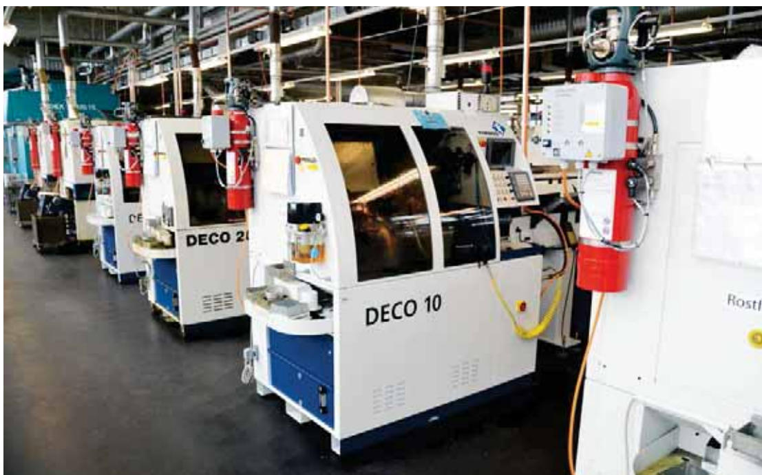
Deco 10 经过了15年密集型运行，在维修之后修复了长期运行中出现的损坏，此时机床就像1997年刚刚购买时一样。
