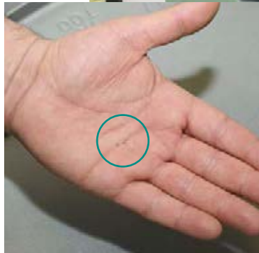
A peça de 1,2 mm de comprimento em aço inoxidável (Inox 4C 27A) fabricada durante o teste passou por quatro etapas de usinagem e é muito utilizada na relojoaria como pé roscado.
