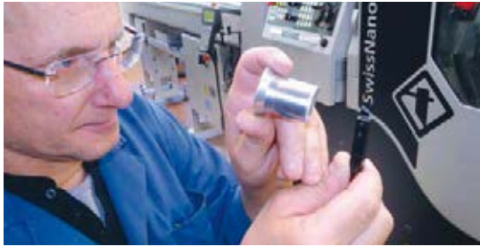
Für den Dreher ist die Art und Weise wie ein Werkzeug verschleisst und welche Farben es aufweist sehr aussagekräftig.
