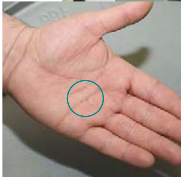
Il pezzo da 1,2 mm di lunghezza in acciaio inossidabile (Inox 4C 27°) fabbricato in occasione del test è passato attraverso quattro fasi di lavorazione ed è utilizzato a milioni in orologeria quale piede filettato.
