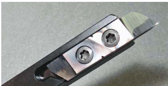
La durata di vita degli utensili e la qualità della superficie ottenuta forniscono direttamente delle indicazioni sulle proprietà qualitative dell'olio da taglio utilizzato.
