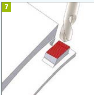
Bearbeitung 7: Zähne fräsen. Werkzeug T12
