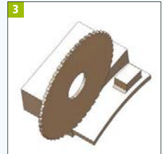
Bearbeitung 3: Rückseite fräsen. Werkzeug T4
