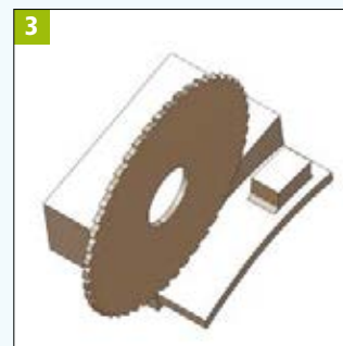
Operazione 3: Fresatura posteriore. Utensile T4
