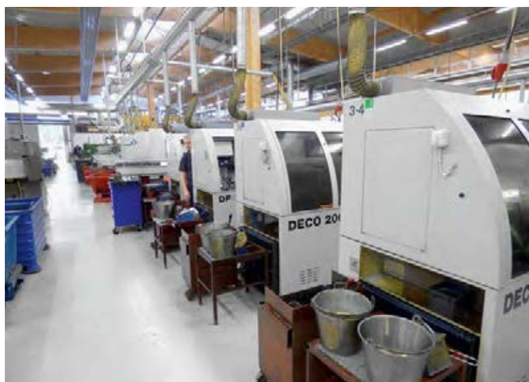
Un processo integrato: la fabbrica di produzione climatizzata accoglie una cinquantina di macchine-utensili di varie generazioni. Solo due olii da taglio sono utilizzati per l'insieme dei processi di produzione.
