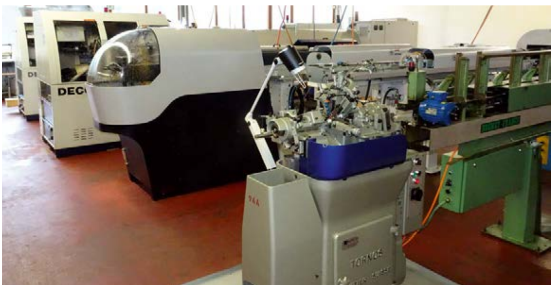
A oficina da Gérald Badan SA inclui máquinas de três gerações que permitem à empresa atender a todas as demandas de até 10 mm de diâmetro.
