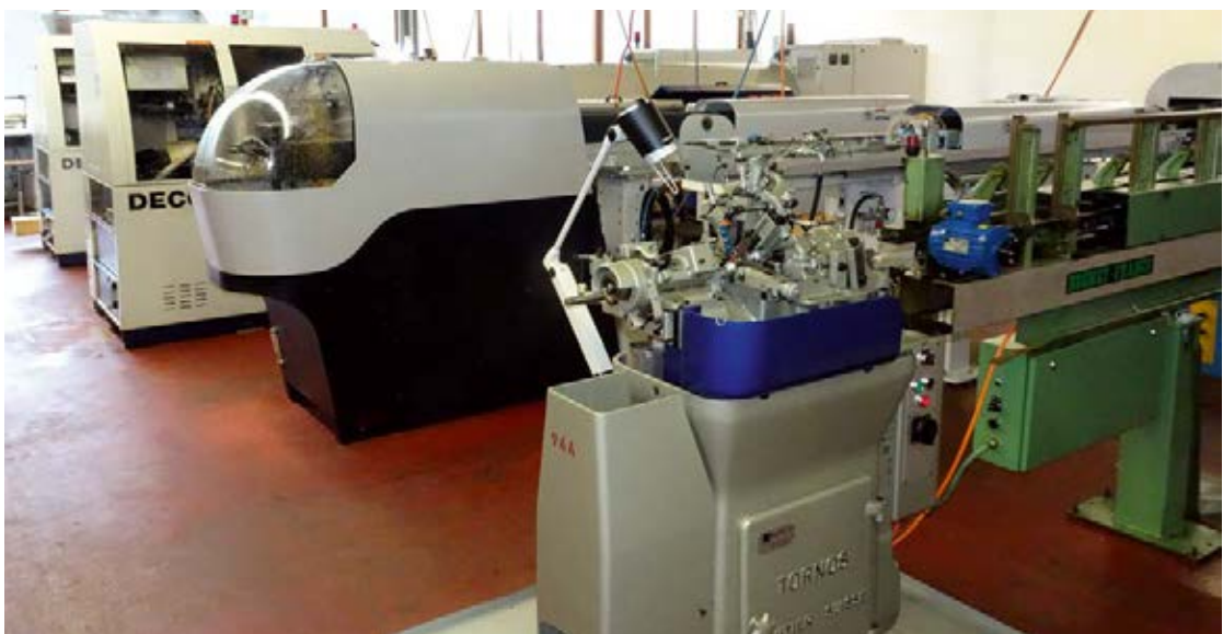
In der Werkstatt von Gérald Badan SA stehen Maschinen aus drei Generationen, mit denen alle Anforderungen an Teilen mit einem Durchmesser bis 10 mm erfüllt werden.
