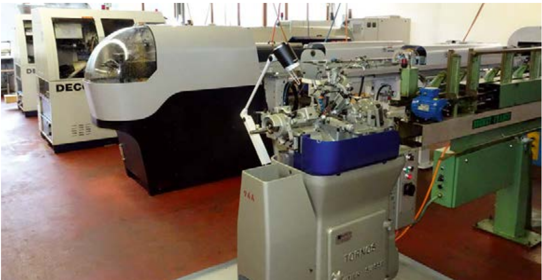
El taller de Gérald Badan SA reúne maquinaria de tres generaciones que le permite responder a todo tipo de necesidades de hasta 10 mm de diámetro.
