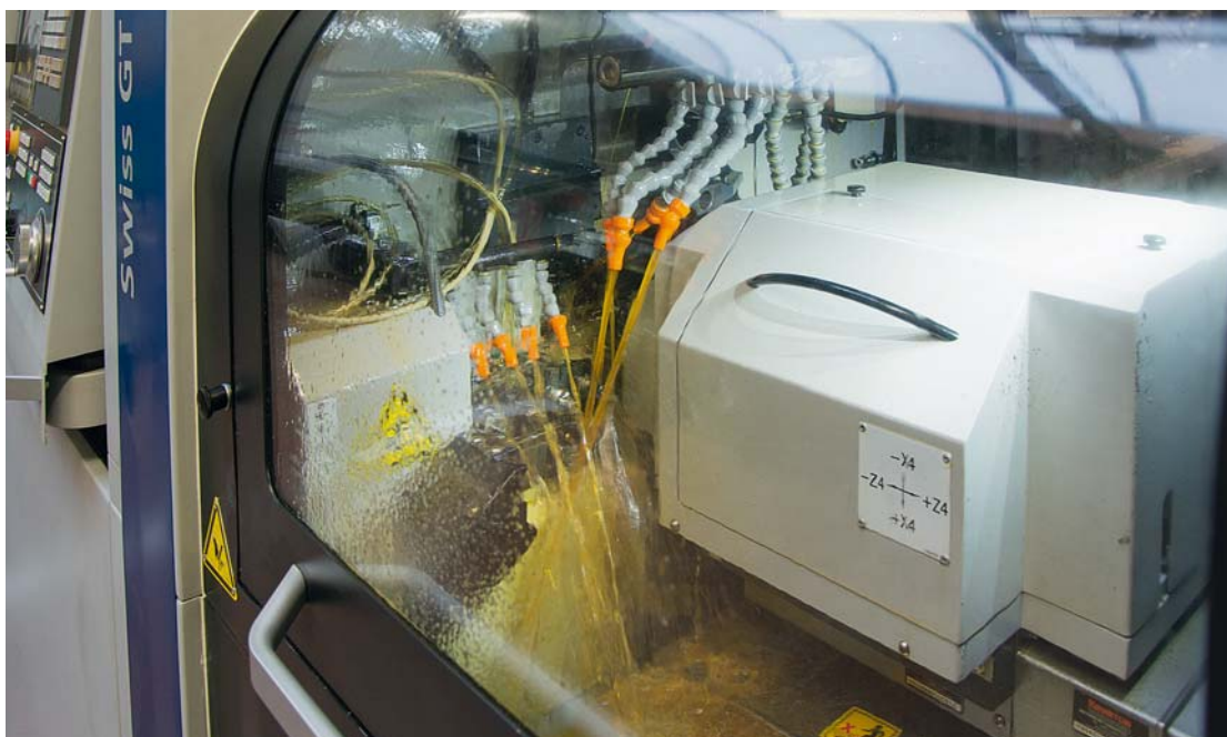
Una Swiss GT 13 mentre produce una vite secabile.
