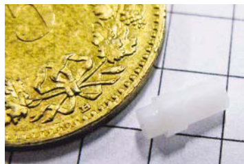
Minúscula peça de plástico torneada.
