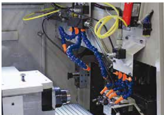
Vista da área de trabalho de um CT20 da Tornos com apenas alguns dos vários eixos. Mostrado do lado esquerdo: Contrapiça CNC para usinagem traseira.
