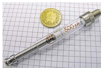
微升注射器的玻璃瓶由数个金属和塑料制成的高精密部件组成。
