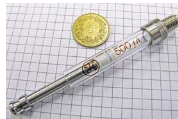
Der Glaskolben dieser Mikroliterspritze wird durch mehrere Präzisionskomponenten aus Metall und Kunststoff komplettiert.
