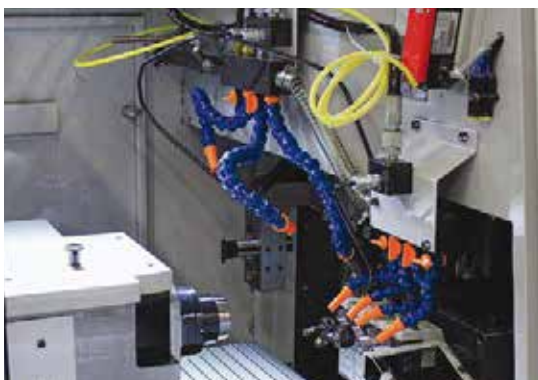
Vista del interior de la zona de trabajo de una CT 20 de Tornos con solo algunos de los numerosos ejes. A la izquierda: Contrahusillo para el mecanizado trasero de la pieza.
