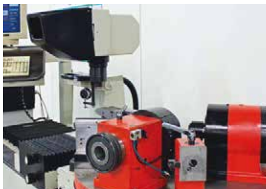
Las herramientas preajustadas con precisión en la estación de ajuste pueden colocarse más tarde en la máquina rápidamente.
