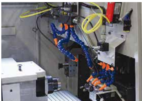
Vista nella zona di lavoro di una CT 20 Tornos con solo alcuni dei numerosi assi. Presentata sul lato sinistro: contro-pinza di serraggio CNC per la lavorazione in contro-operazione.
