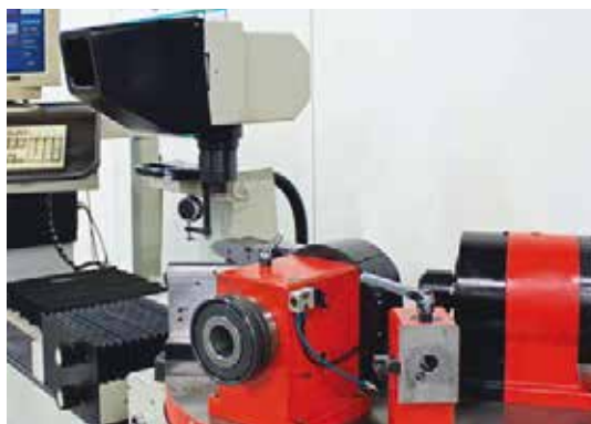
Gli utensili che sono stati prerogolati con precisione nell'apposita stazione di regolazione, possono essere caricati nella macchina e li regolati in solo qualche semplici tappe.
