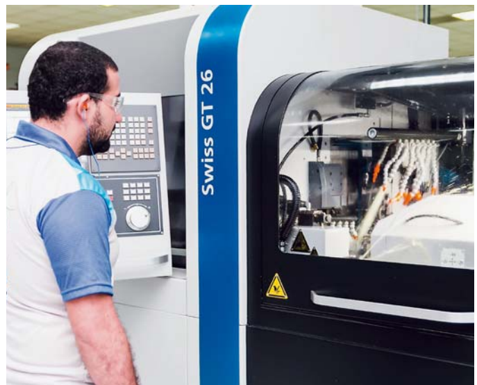
Maschinentechner Leslie Bonilla vor der Tornos Swiss GT 26, einer mit Wälzfräsmodule ausgestatteten Maschine.
