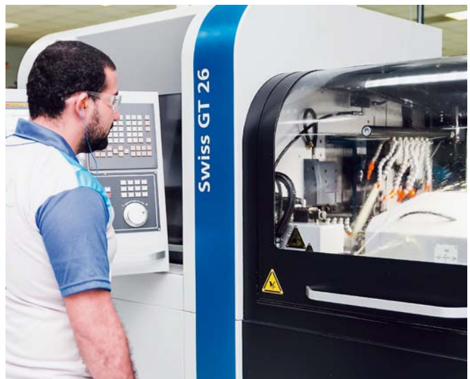
Leslie Bonilla, tecnico specializzato, di fronte alla macchina Swiss GT 26 Tornos, la macchina è dotata di un dispositivo per la dentatura a creatore.
