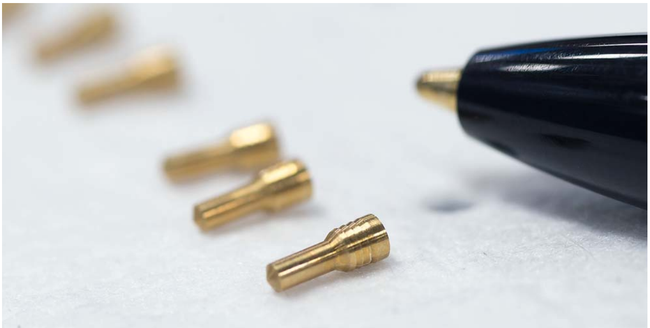
Un componente estremamente preciso di un dispositivo medico, in ottone, prodotto con la nuova SwissNano da Cox Manufacturing.
