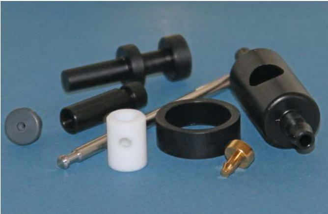
在CTPE，机床设置的零件生产批量通常在1000到2000个。由于机床设置简单快速，Taylor先生说，进行300至400件的小批量生产同样是经济划算的。CTPE加工的零件平均长度大约20 mm、直径大约15 mm，而一些零件还具有复杂的特征，例如软管用的端钩配件以及侧孔等。Swiss DT 26上典型的循环时间为20秒，对于更复杂的部件，循环时间可达50秒。
