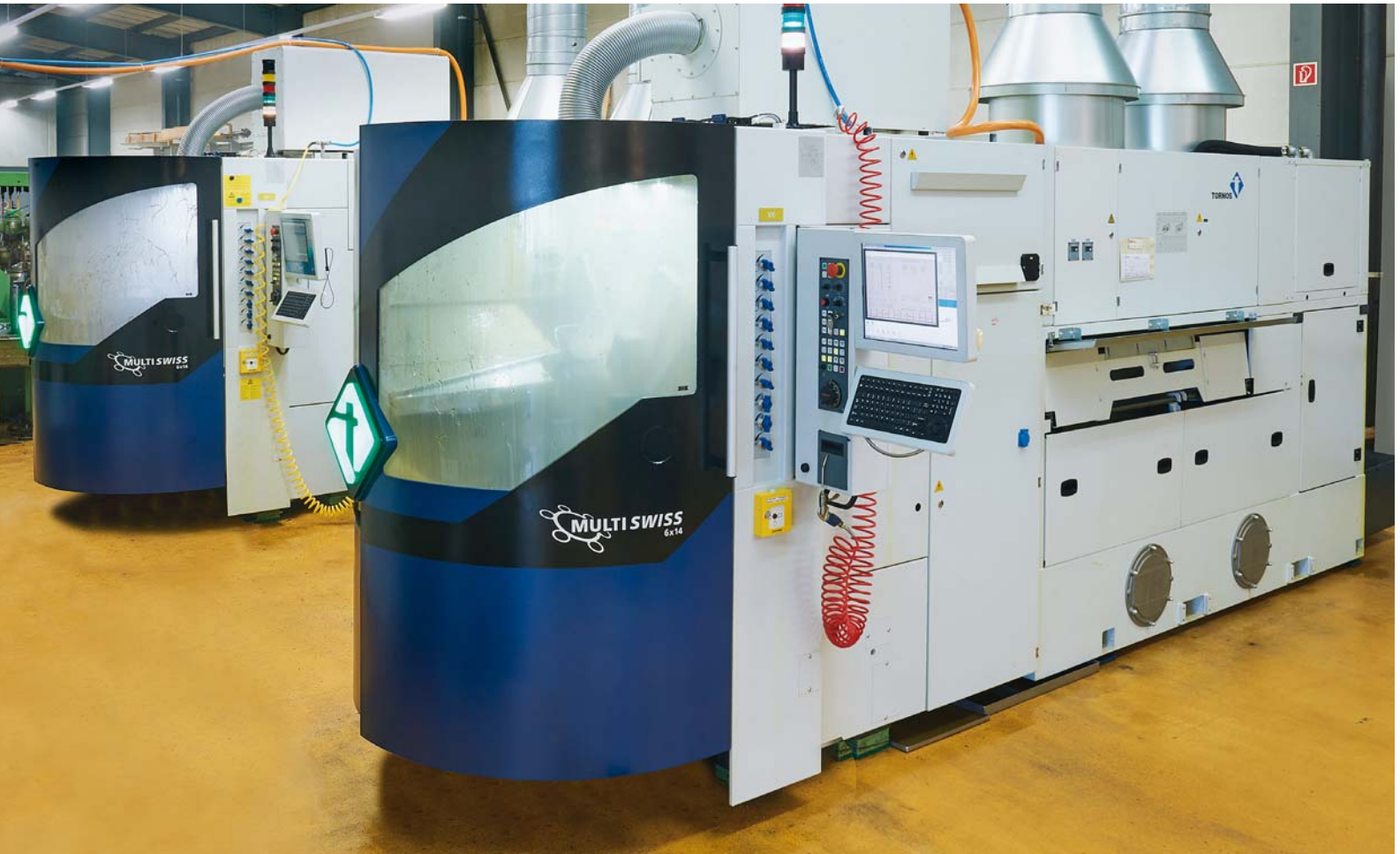
使用中的Tornos MultiSwiss自动车床6x14。
