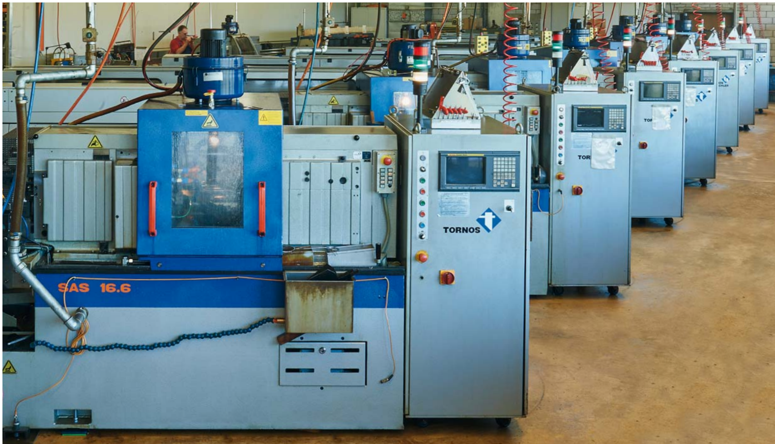
在RB-Cema，总共使用了17台由Tornos公司生产的凸轮控制的多轴自动车床SAS 16.6和AS 14。
