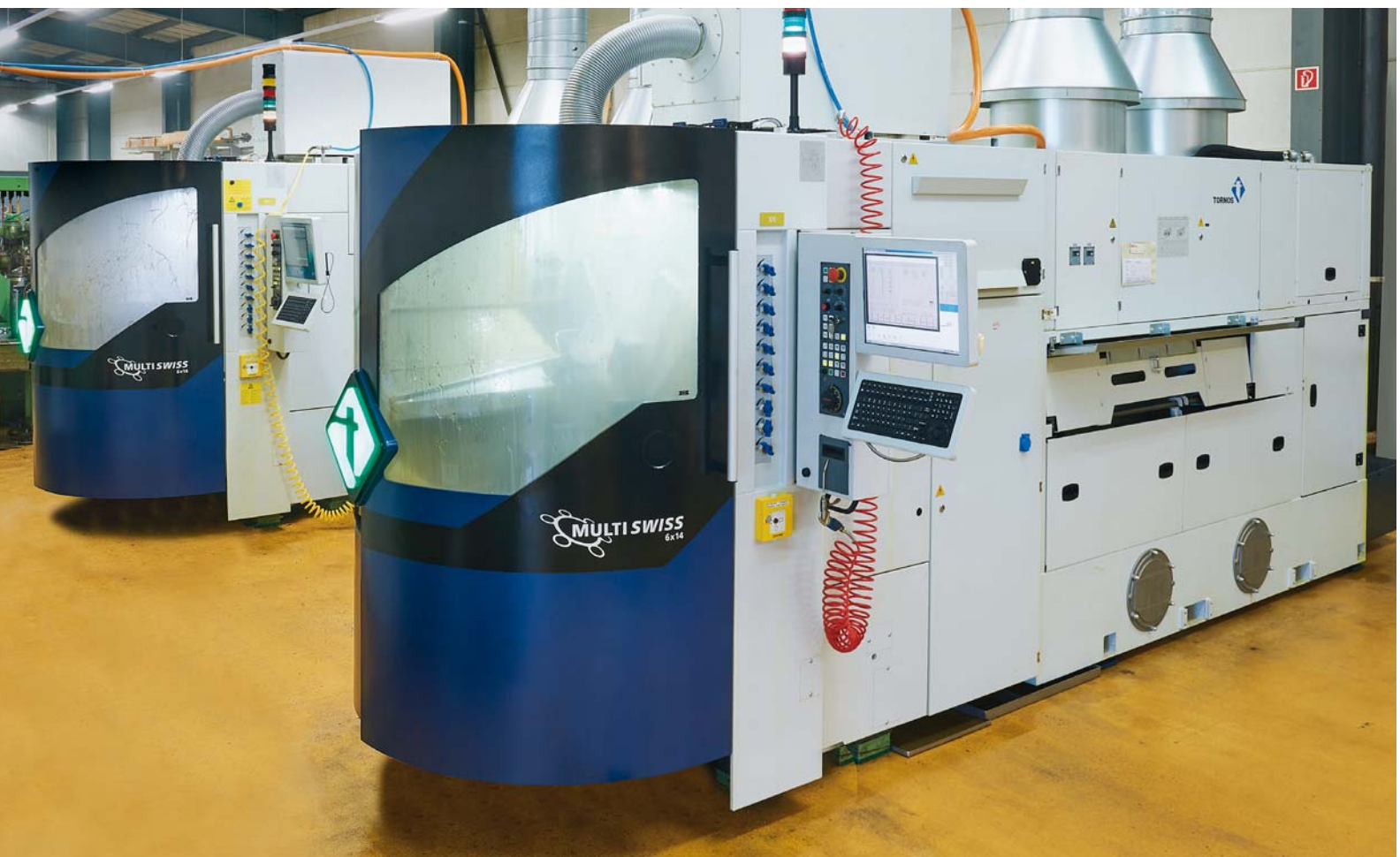
I due torni automatici MultiSwiss 6x14 di Tornos in utilizzo.
