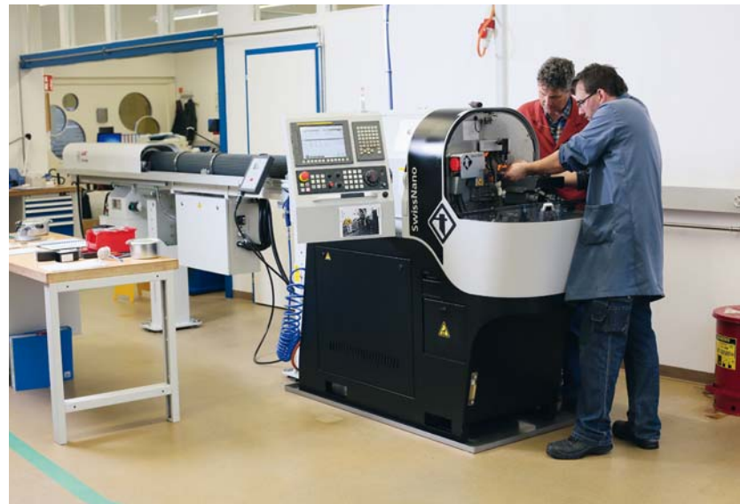
Professor e aprendizes: a máquina SwissNano, na qual os aprendizes são especialmente ensinados na fresagem de engrenagens.
