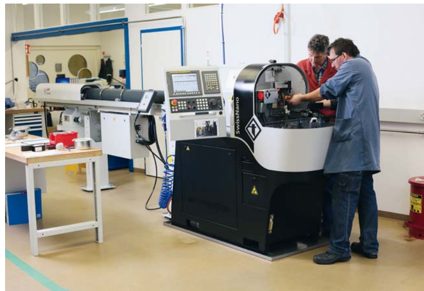
Lehrer und Auszubildende: die SwissNano, an der die Auszubildenden vor allem im Wälzfräsen unterwiesen werden.
