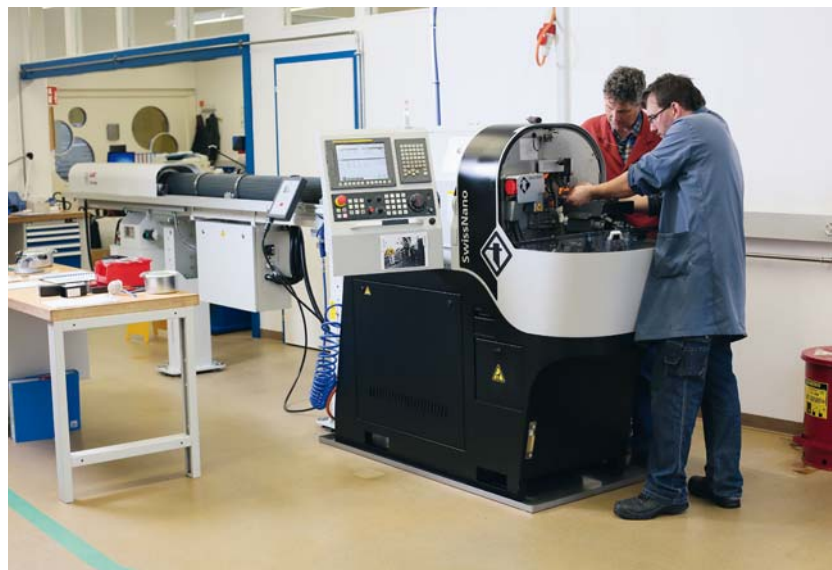
Formador y aprendices: SwissNano sobre la cual los aprendices reciben formación en el tallado por fresa madre.
