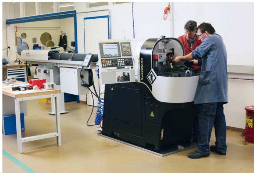
Enseignant et apprentis: la SwissNano sur laquelle les apprentis apprennent notamment le taillage par génération.
