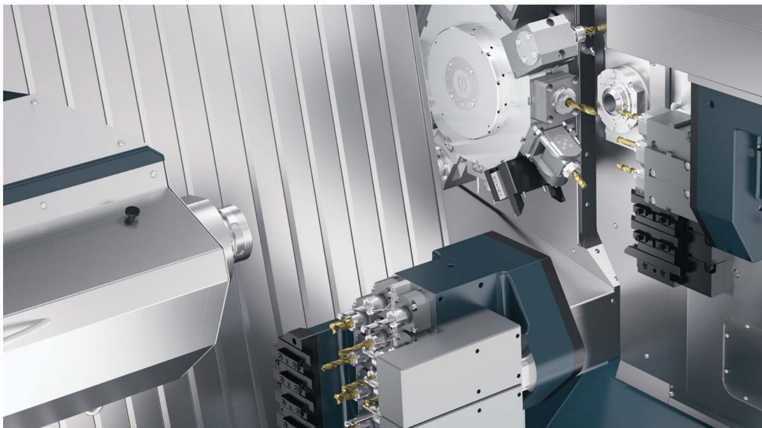
A versão com a coluna de ferramentas e a torre está disponível com ou sem o eixo B.
