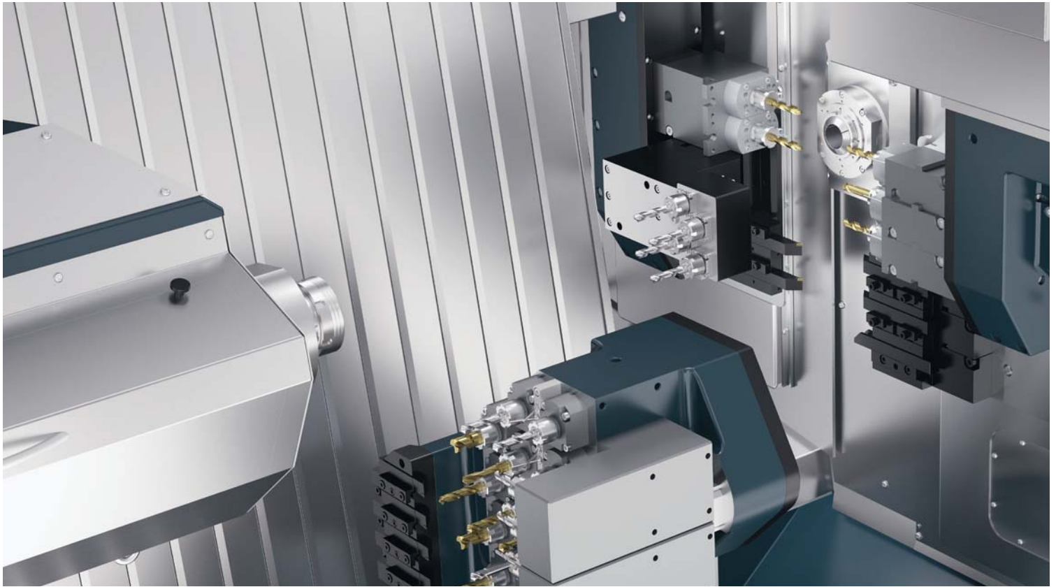
La versión con portaherramientas múltiple doble está disponible con o sin eje A.
