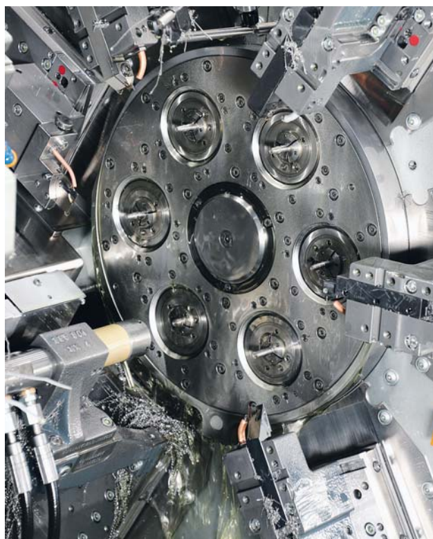
Compartimento de mecanizado de la MultiSwiss con componentes para automóviles en cada husillo.
