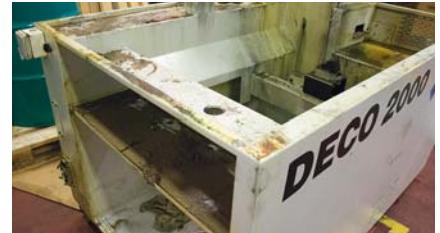
如果需要彻底大修，机床将被全部拆解和翻新。
