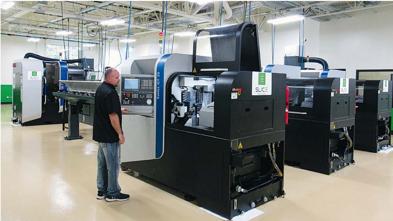
Brad Fowler, 制造技术专家在 Slice Mfg. Studios - 三台 Swiss GT 26 机床的全图。
