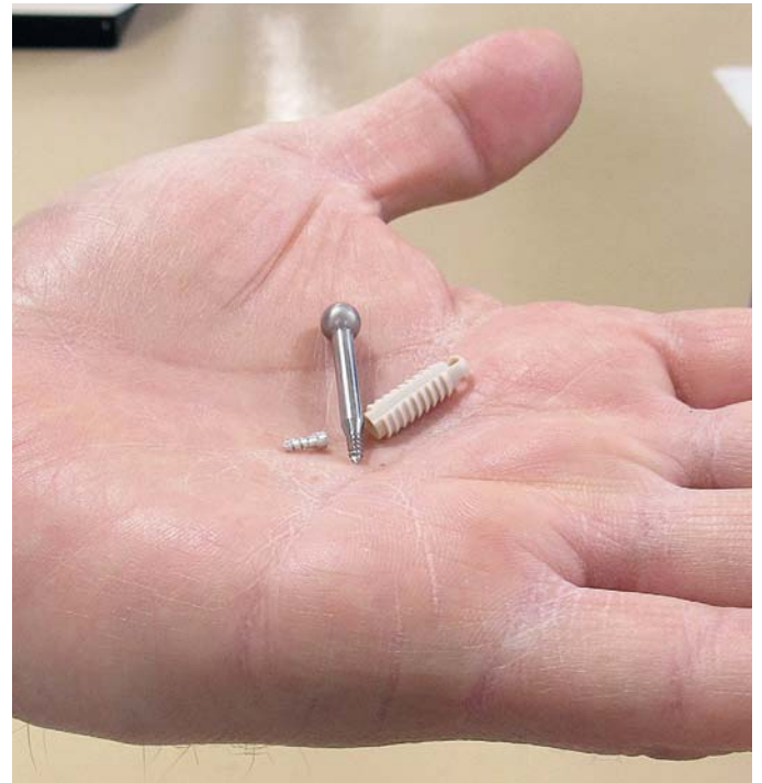
镁和钛合金骨头螺钉以及PEEK（聚酯醚酮）原型植入物。
