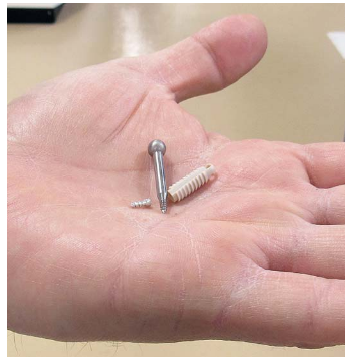
Tornillos ortopédicos de magnesio y titanio, y prototipo de implante PEEK.
